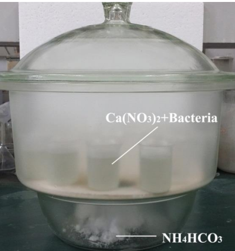
图 2 碳酸酐酶菌加速诱导碳酸钙沉积试验装置图
